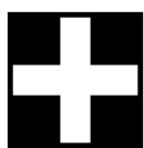
**Signal d'arrêt manœuvre** (position de base) selon R 300.2, fig. 304 (non illuminé de nuit). Arrêt pour les mouvements de manœuvre devant le signal. Si le signal est valable pour plusieurs voies, le point d'arrêt se situe au signal limite de garage de l'aiguille concernée.
